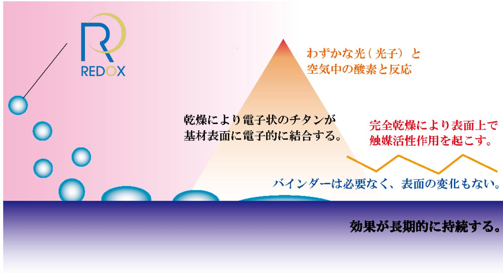
酸化チタン素粒子分散液(REDOX)は、対象物に噴霧することで、水中の酸化チタン素粒子が対象物表面の原子と電子結合することから、バインダー等を必要とせず、また、対象物の素材・質感を変えることなく、触媒効果を長期間にわたって持続させることが可能です。触媒機能は、どれだけの光を受け取ることができるか、つまり、基材の表面にどれだけ広く露出しているかが重要な要素であり、本剤はその点、基材表面の原子と電子結合するため、基材全面に触媒機能を持たせることができます。
